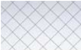
磨菱形ワイヤー (線間隔約20mm)
