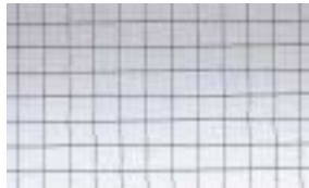
磨角形ワイヤー (線間隔約13mm)
