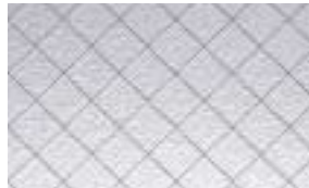
菱形はつしもワイヤー(線間隔約20mm)
