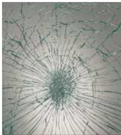
ラミレックスUV(合わせガラス)の割れパターン
